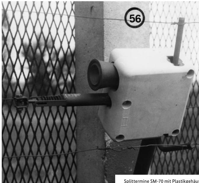
Splittermine SM-70 mit Plastikgehäuse
